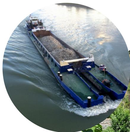
Barge à clapet fendable
