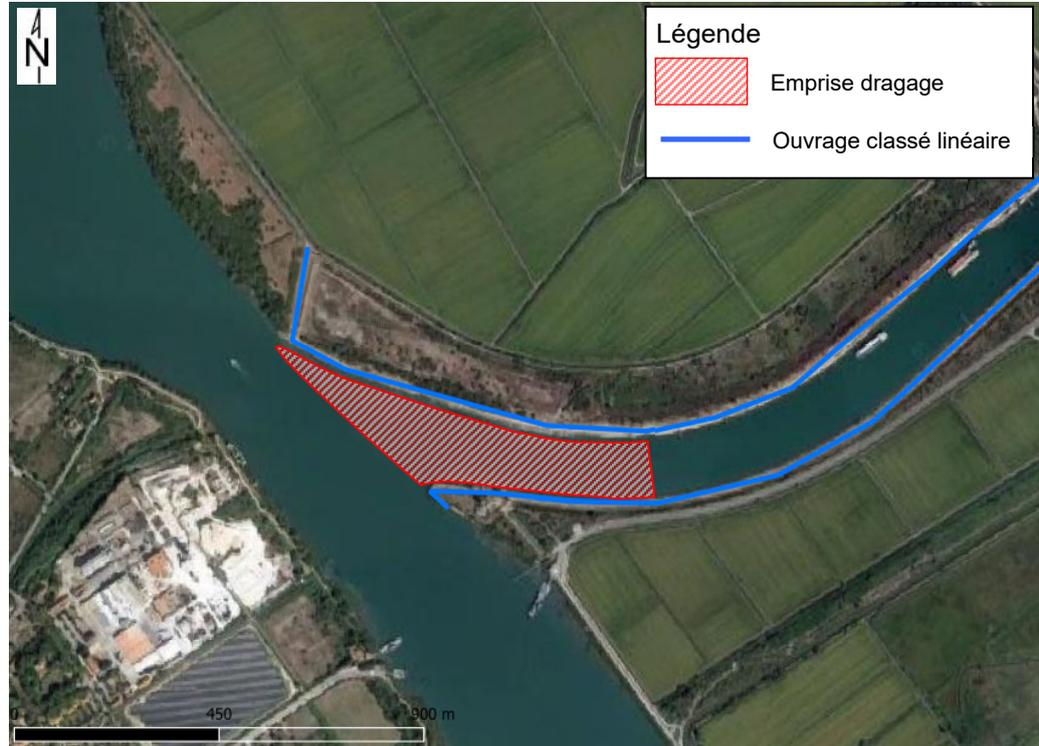
Figure 17. Ouvrages classés à proximité des travaux (CNR 2025)
