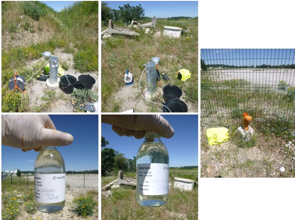
Figure 3 : Matériel de prélèvement utilisé et échantillon prélevé dans Pz1 e Pz2
