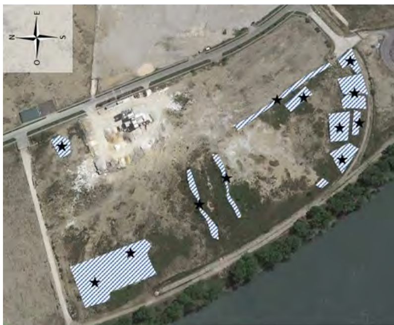
Figure 7 : Carte de localisation des principaux merlons et tas de déblais
