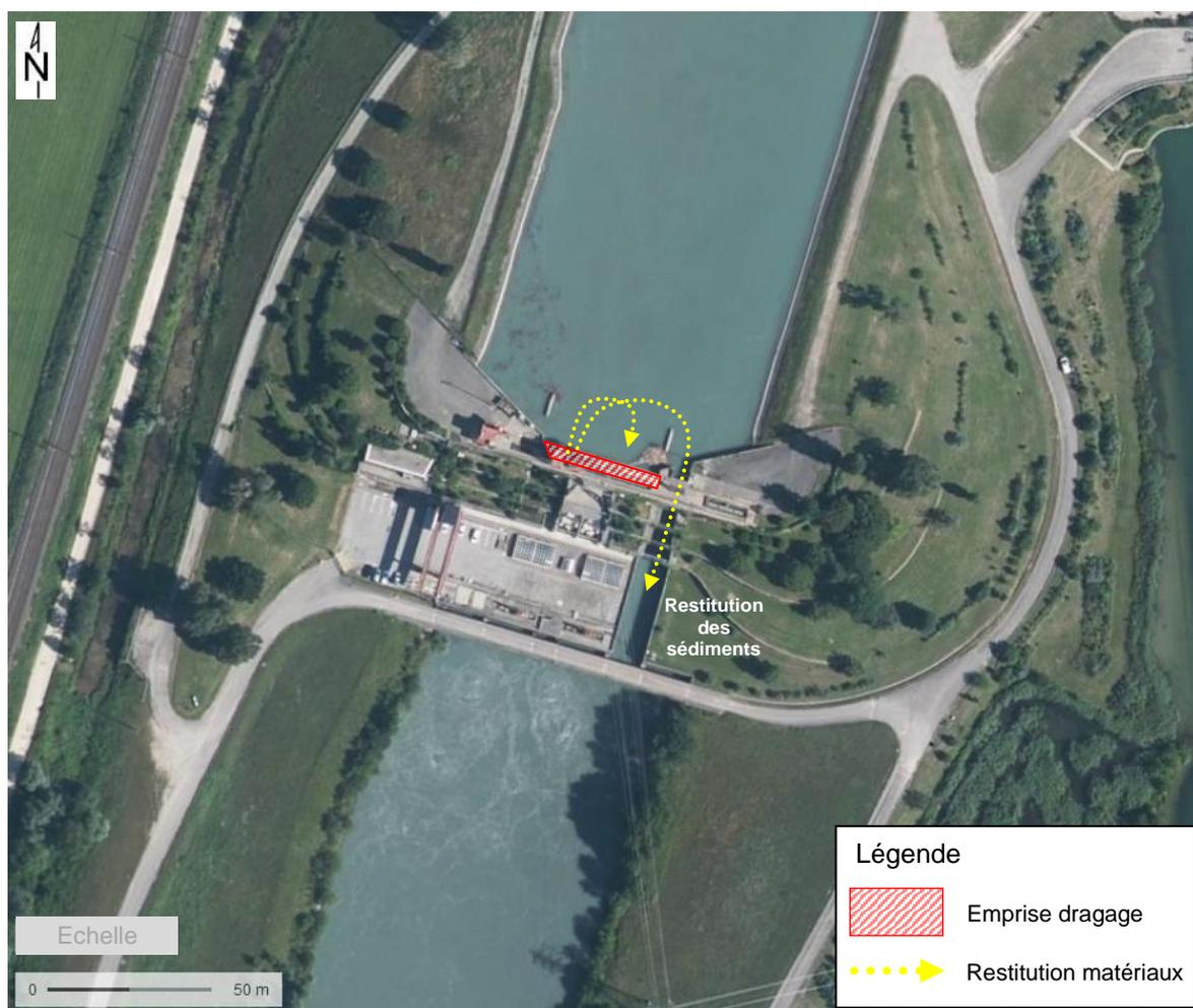
Les travaux sont réalisés par des plongeurs avec du matériel manuel (lances haute pression et airlift) pour une restitution soit à l'amont des groupes, soit dans le canal de défeuillage en rive gauche de l'usine.
