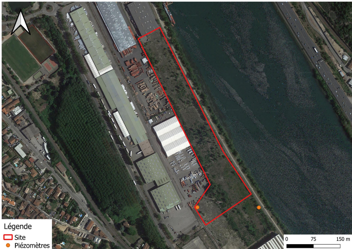
Figure 3 : localisation des piézomètres constatés sur ou à proximité du site
