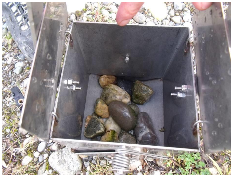
Figure 7. Prélèvement de sédiment à la benne preneuse dans le chenal navigable (CNR -2014)
