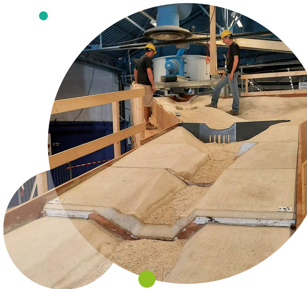
CNR évalue sur un modèle physique le fonctionnement et les réaménagements possibles de l'ouvrage de régulation sédimentaire du Manival (Isère), l'un des torrents les plus actifs et les plus aménagés des Alpes.
