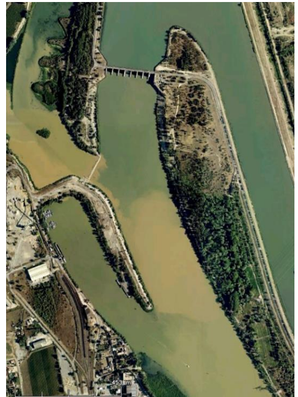
Figure 3. Remises en suspension dans le Vieux-Rhône de Caderousse par les eaux de la Cèze (Google Earth consulté le 17/01/2012)
