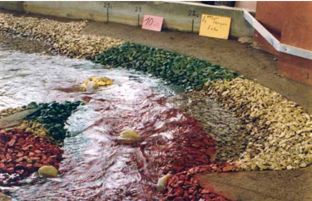
Modèle physique d'une rivière artificielle
