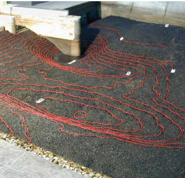
Cartographie bathymétrique après essai sur modèle à fond mobile
