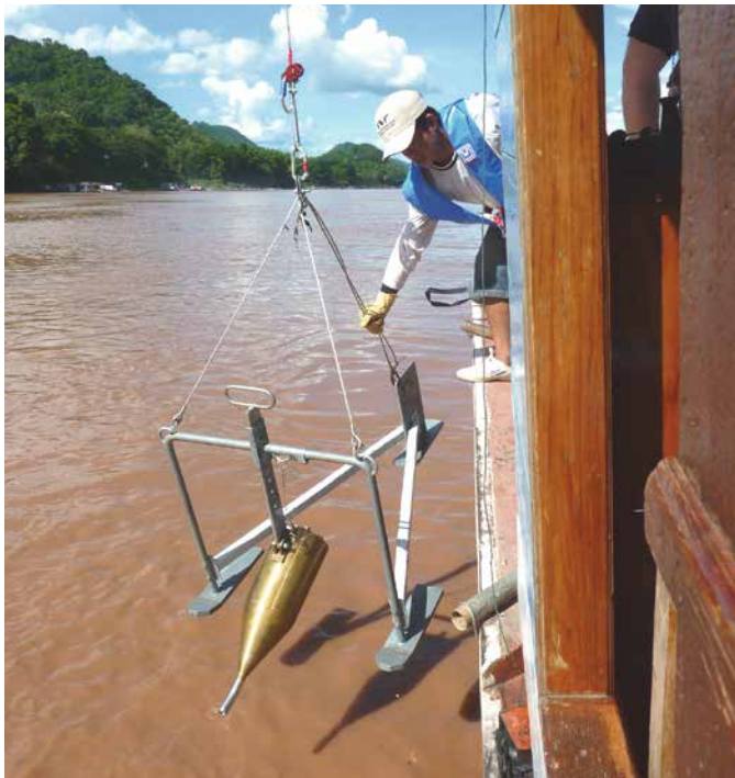
Mesure des flux de sable en suspension du Mékong au Laos
