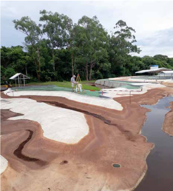
Modèle physique du barrage d'Itaipu
