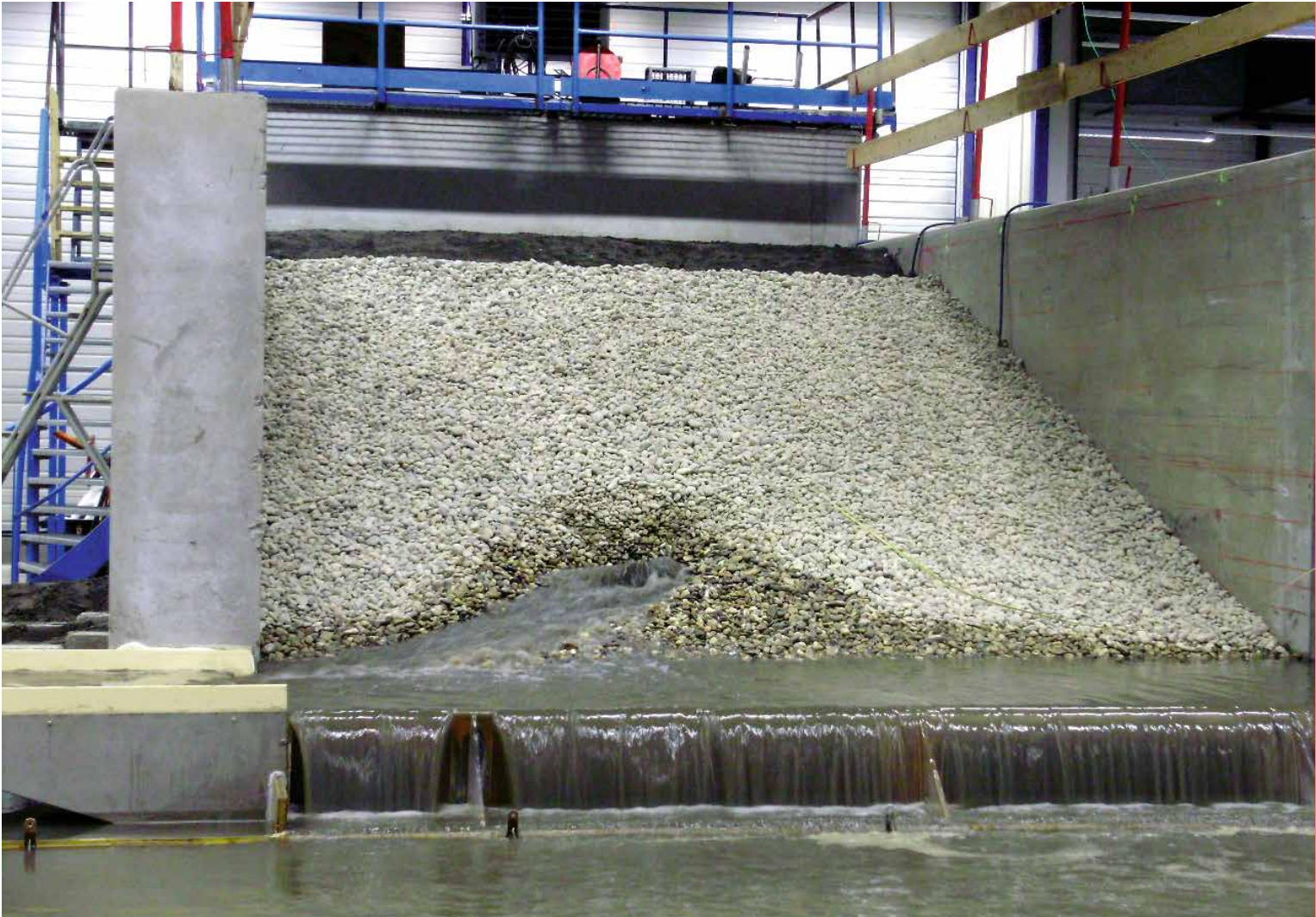
Etude des processus d'érosion interne des digues sur modèle physique
