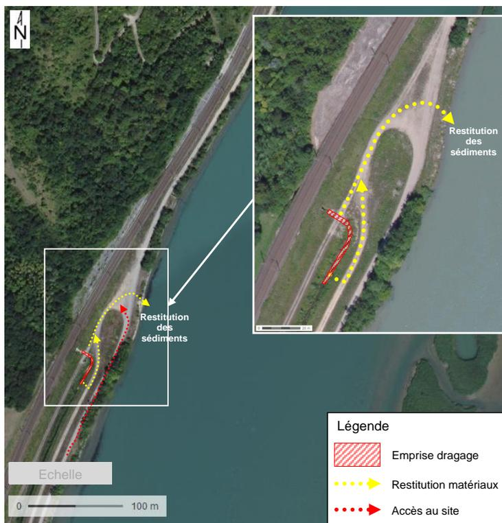
L'entretien est réalisé avec une lance à eau pour dégager les buses et du matériel terrestre (pelle mécanique et camion). La restitution au fleuve en berge est réalisée à l'aide du camion depuis la berge avec une reprise à la pelle mécanique si nécessaire pour répartir les matériaux dans le fleuve.
