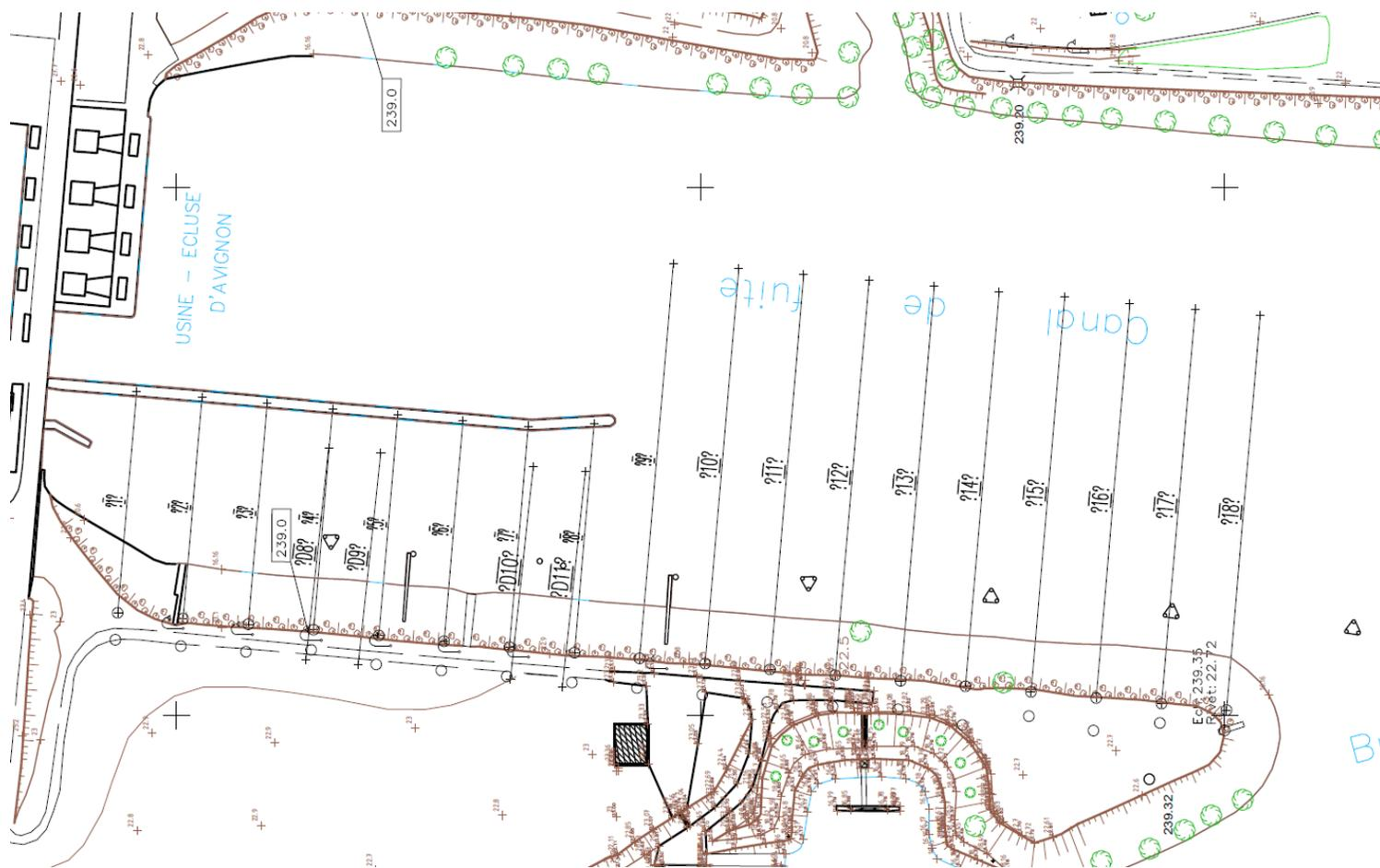
Figure 16. Vue en plan globale du garage amont d'Avignon– Identification des principaux profils entre P1 et P18 (CNR 2020)
