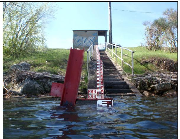
Figure 3. Echelle limnimètre en berge
