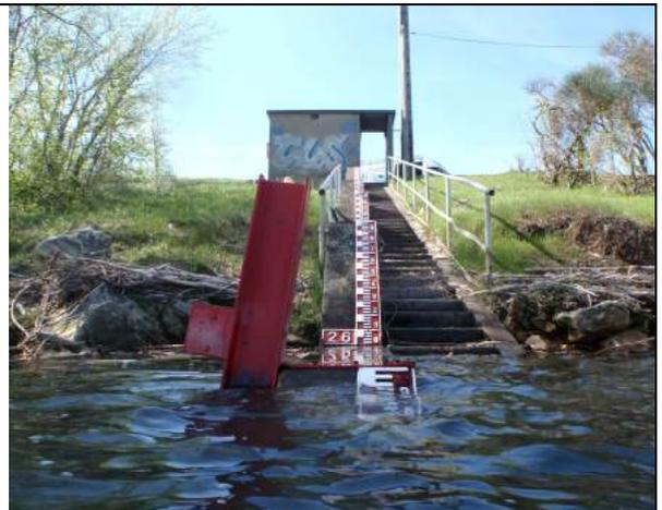
Figure 3. Echelle limnimètre en berge
