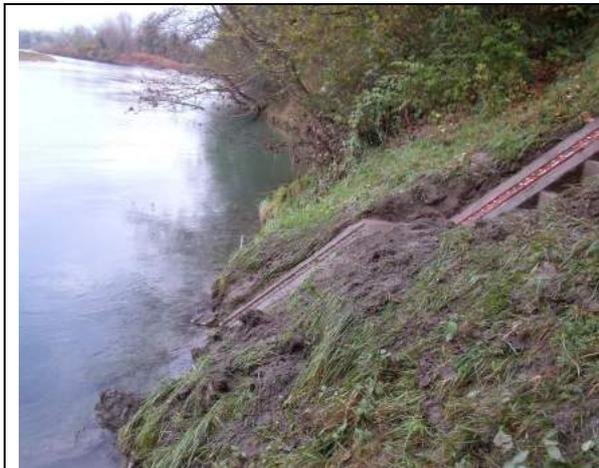
Figure 2. Echelle limnimétrique
