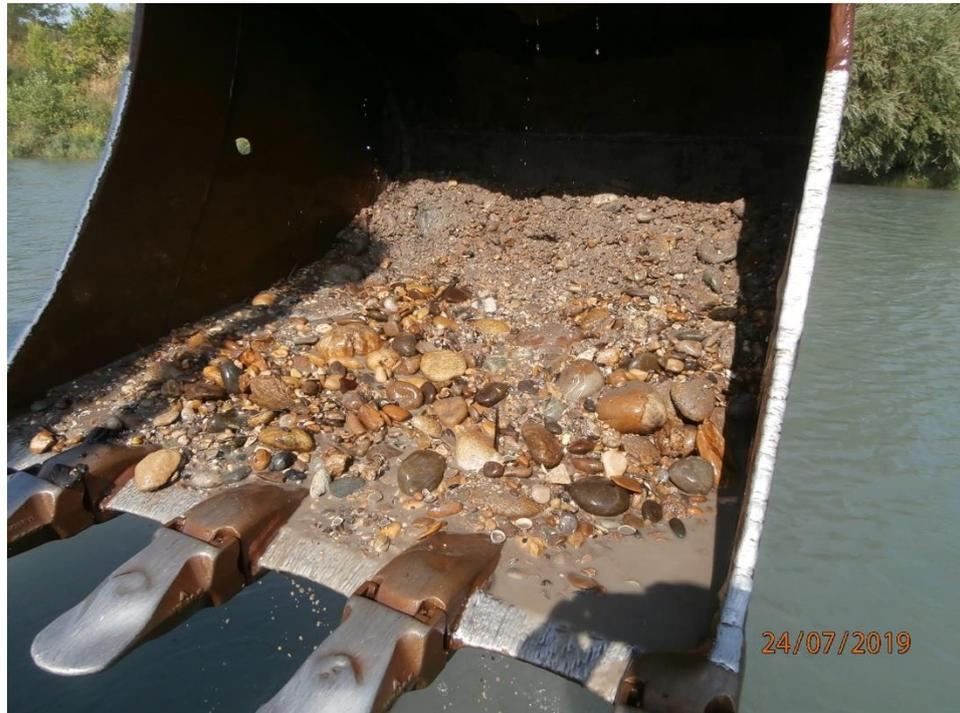
Figure 5. Caractérisation des sédiments (CNR 2019)
