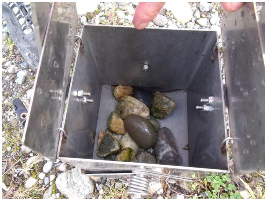
Figure 6. Prélèvement de sédiment à la benne preneuse dans le chenal navigable (CNR -2014)
