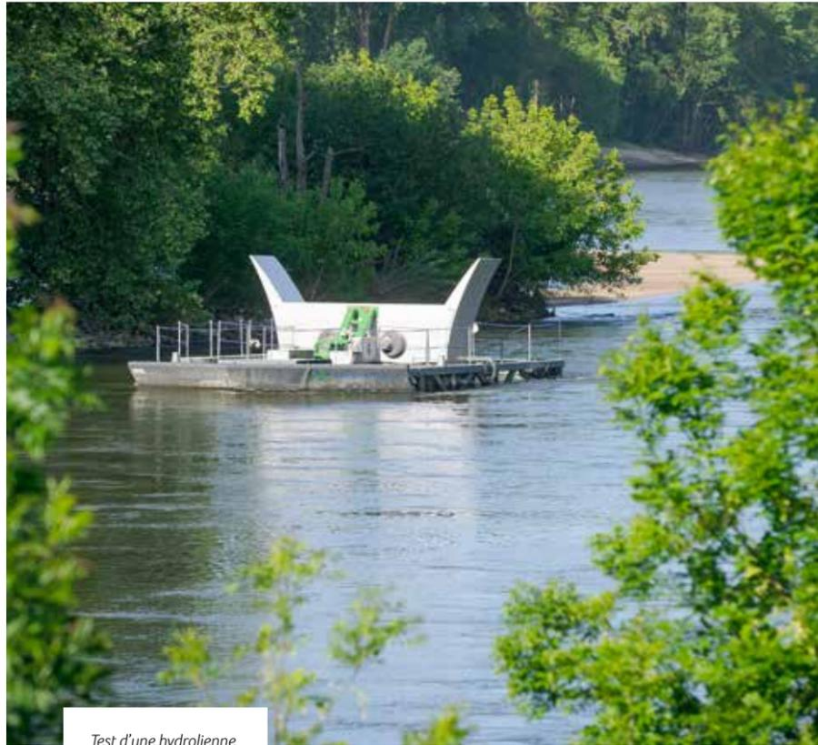
Test d'une hydrolienne fluviale sur la Loire.
