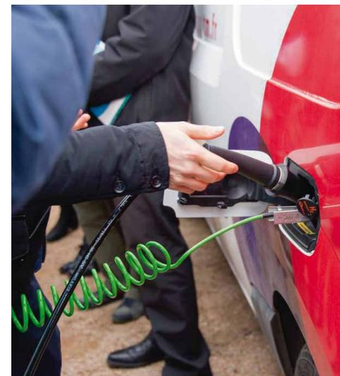
Recharge d'un véhicule à hydrogène
