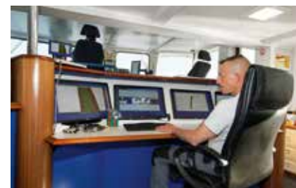
Contrôle bathymétrique du chenal navigable en temps réel
