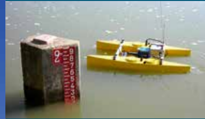
ADCP sur catamaran radiocommandé
