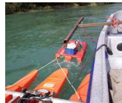
Contrôle de débit multi ADCP
