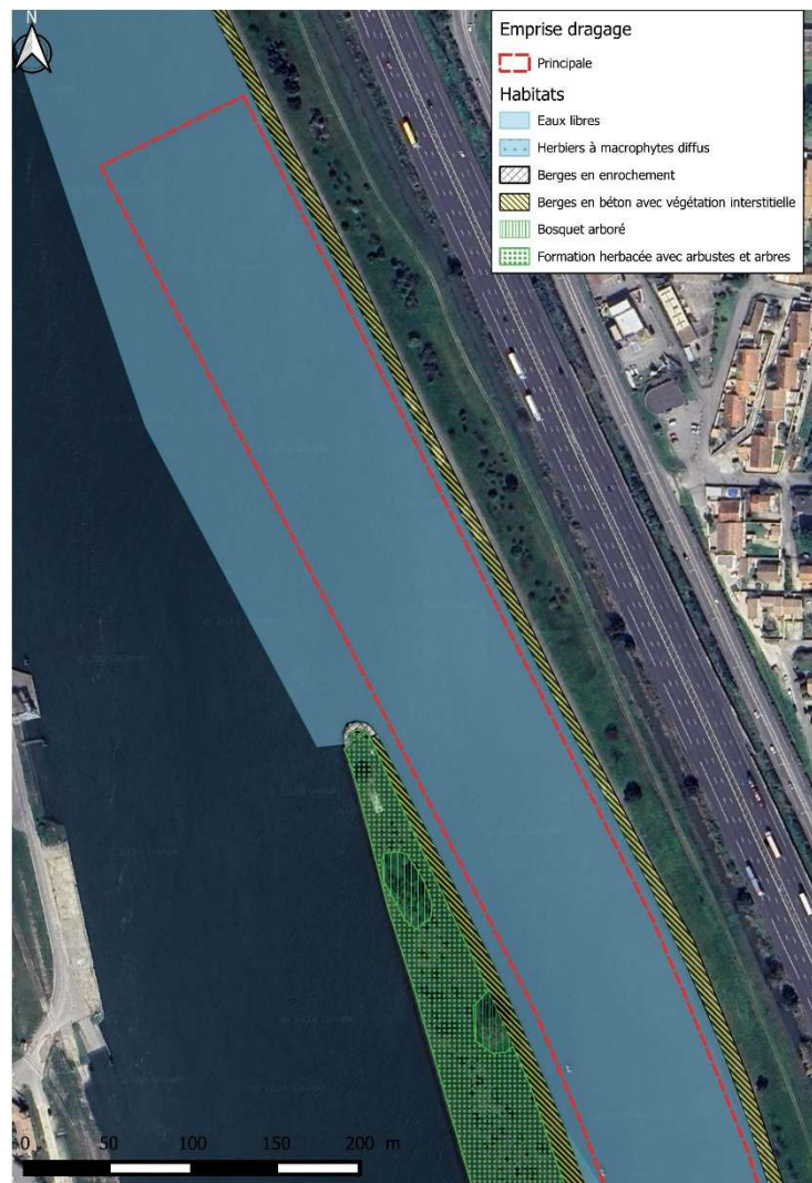
Figure 7. Localisation des habitats dans l'emprise de dragage au nord du garage amont de l'écluse de Bollène (© Google satellite 2026).
