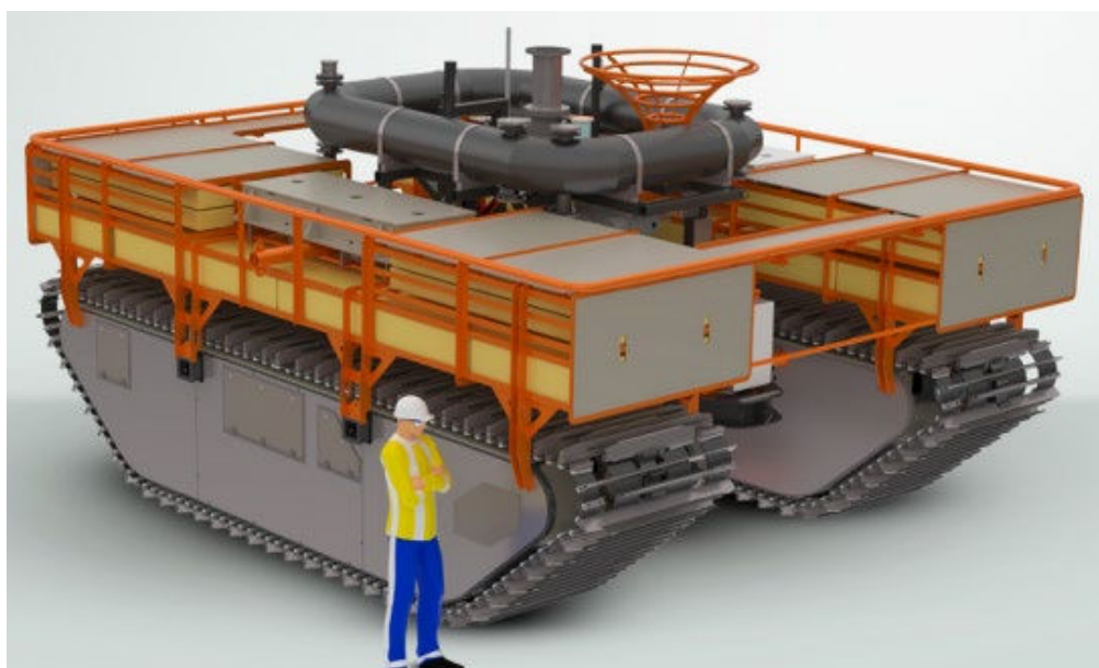
Figure 4. Vue 3D du robot de dragage Nessie (Watertracks, 2025)
