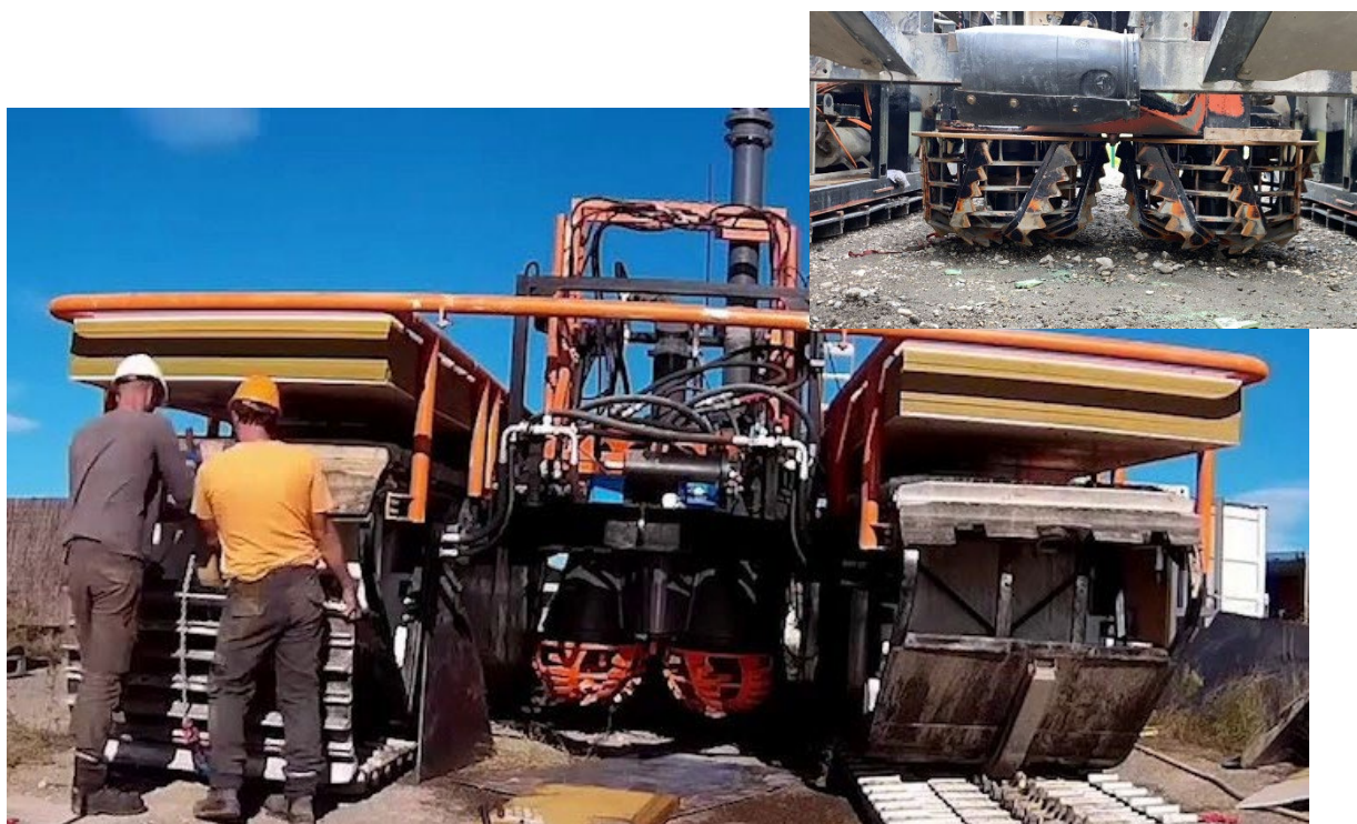
Figure 6. Le robot Nessie et ses cutters de dragage
