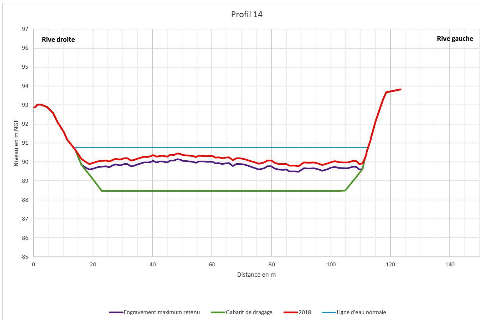
Figure 23. Profil en travers P14 avec gabarit de dragage complet sur l'ensemble du lit
