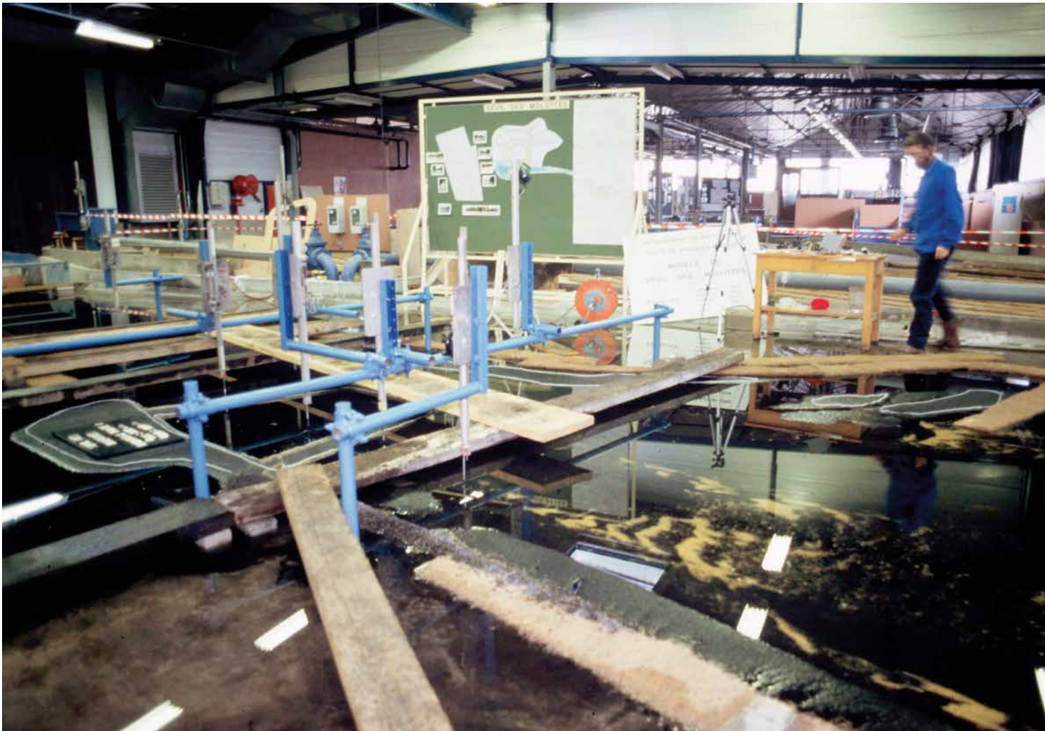
Modèle physique pour l'étude hydraulique du TGV sud-est
