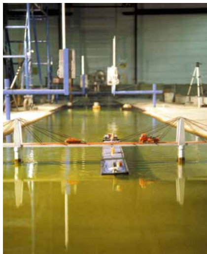
Maquette pour une étude de convoi poussé dans un chenal de navigation
