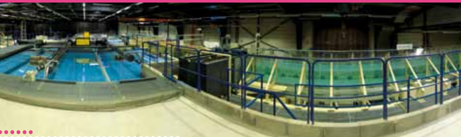
MODÈLE PHYSIQUE DU SYSTÈME D'ALIMENTATION HYDRAULIQUE DES NOUVELLES ÉCLUSES DU CANAL DE PANAMA
